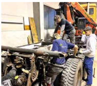
In Eigeninitiative der Feuerwehr wird ein ausrangierter Gemeindegelastwagen von Grund auf generalüberholt, um diesen als Feuerwehr-LKW in den Dienst zu stellen.
