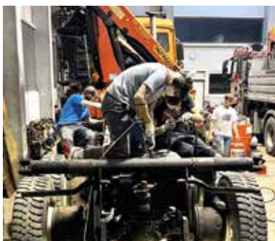
In Eigeninitiative der Feuerwehr wird ein ausrangierter Gemeindegelastwagen von Grund auf generalüberholt, um diesen als Feuerwehr-LKW in den Dienst zu stellen.
