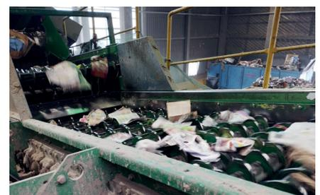
Wellenförderband, bei dem das Kleinmaterial nach unten auf ein Förderband fällt und in einer eigenen Kammer gesammelt wird.
